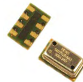
▲ Slika 2 - piezo-uporovni senzor absolutnega zračnega tlaka
