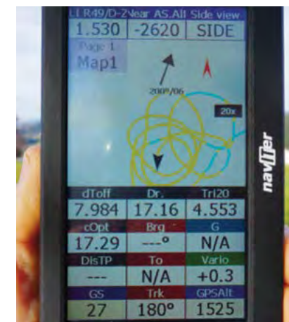
▲ Variometer z žiroskopom, merilnikom pospeška in magnetometrom deluje zelo natančno, pilot ima dodatno pomoč pri termičnem centriranju z grafiko (rumsna označuje vzpenjanje, modra pomeni spuščanje) ...
